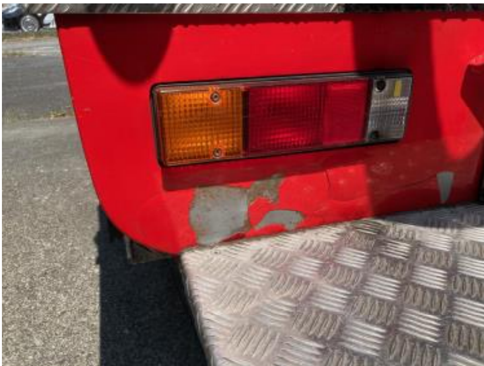
車両後部左側塗装剥がれ状況
